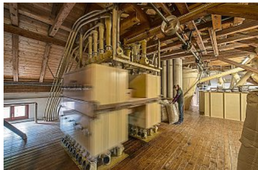
Wackelkandidat: Im „Plansichter“, der hektisch vor sich hinrüttelt, trennen 180 Siebe das Mahlgut in seine Bestandteile.
